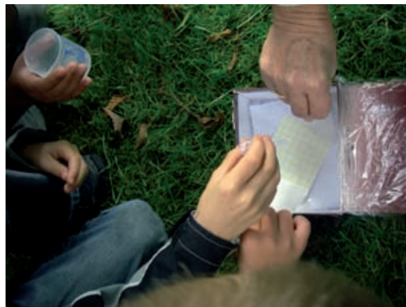
Præcis 1 ml vandprøve blev afsat på en Petrifilm, som indeholdt et vækstmedium, hvor bakterierne kunne vokse frem i synlige kolonier.
